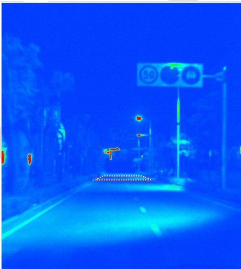
图 A. 3 测量视场（虚线框内为测量区域）
